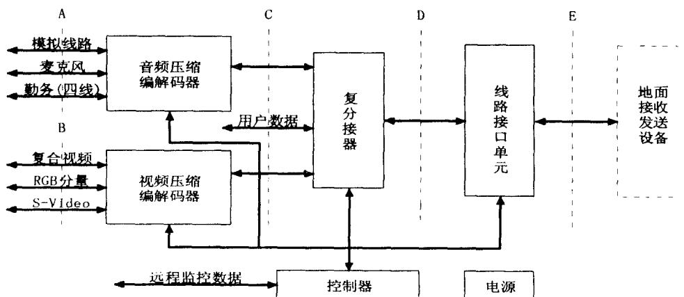
注：A—音频模拟接口；B—视频模拟接口；C—数字业务接口；D、E—群路信号接口。
